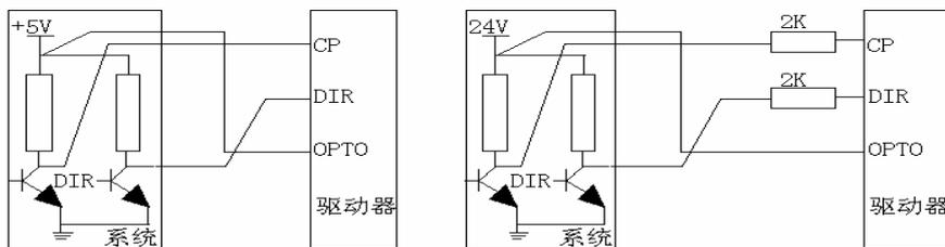
◇ 西门子 PLC (S7 CPU226), 与共阳驱方式驱动器连接图:
